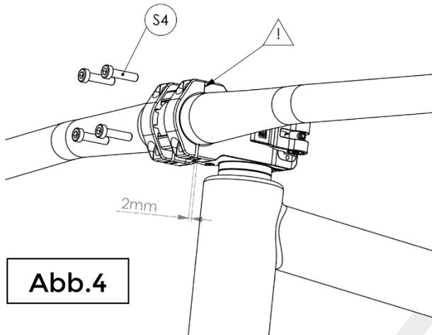
Die Lenkerdeckel sind mit den oberen beiden Klemmschrauben **[S4]** am Vorbau anzulegen **[Abb. 4]**. Nach dem Ausrichten des Lenkers in Höhe und Neigung, die Schrauben **[S4]** **[Abb.4]** mit einem Drehmoment von **6-8Nm** festziehen (erst die oberen beiden Schrauben, danach die unteren beiden Schrauben!).
