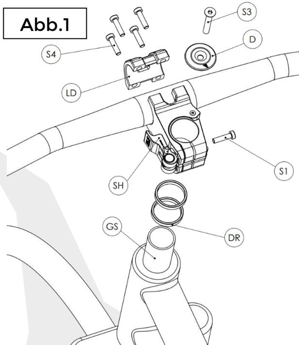
Der Vorbau ist mittels Distanzringe **[DR]** (Zubehör, nicht im Lieferumfang enthalten) so auszurichten, dass er ca. 1,5 – 2 mm über dem Gabelschaft übersteht. Nach dem Ausrichten stellt Ihr das Lagerspiel ein, in dem Ihr den **Ahead-Deckel [D]** mit der Schraube **[S3]** mit ca. **1,5 – 2 Nm** anzieht. Dabei ist darauf zu achten, dass die Klemmschraube **[S1]** lose ist.
