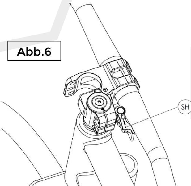
Der Vorbau/Lenker kann nun 90° Grad zu Seite geschwenkt werden. Dieser rastet in Endstellung ein. Den Spannhebel **[SH]** bitte in der „Parkposition“ festspannen **[Abb.6]**. In dieser Position bitte das Fahrrad nicht am Lenker anheben!
