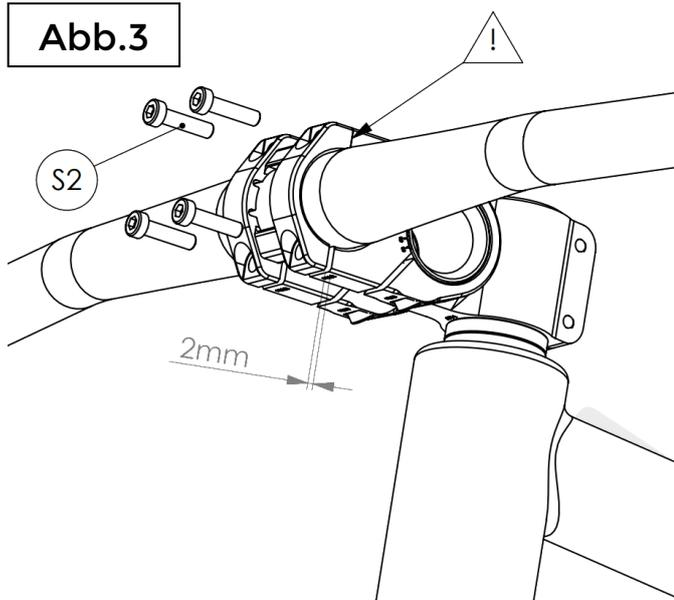
Die Lenkerdeckel erst sind mit den oberen beiden Klemmschrauben [S2] am Vorbau anzulegen [Abb. 3]. Danach bitte die Höhe und Neigung des Lenkers ausrichten [Abb. 4], dafür sind die Klemmschrauben [S4] [Abb.4] zu lösen.
